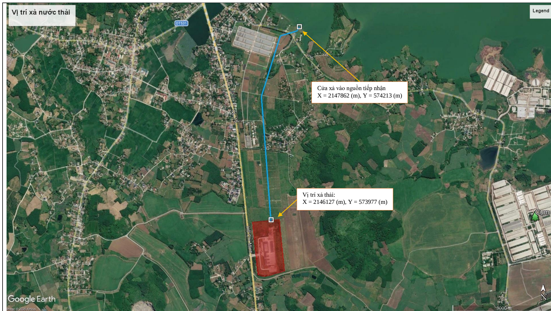
Hình 3. 5. Sơ đồ tuyến ống dẫn nước thải sau xử lý vào hồ Sông Sào
